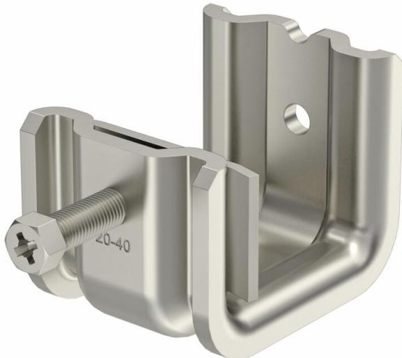
Ce type de pince de fixation est poussé sur le support et fixé sur le support ou un fer plat au moyen d'un patin de pression et d'une vis (M8). La vis hexagonale est dotée d'une cote sur plat de 10 mm. En outre, dans le corps de bride, deux autres filets M6 sont prévus pour fixer entre autres des tiges filetées.
