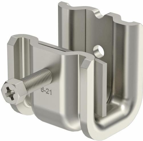
Ce type de pince de fixation est poussé sur le support et fixé sur le support ou un fer plat au moyen d'un patin de pression et d'une vis (M8). La vis hexagonale est dotée d'une cote sur plat de 10 mm. En outre, dans le corps de bride, deux autres filets M6 sont prévus pour fixer entre autres des tiges filetées.
