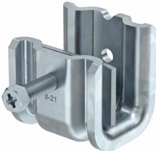
Ce type de pince de fixation est poussé sur le support et fixé sur le support ou un fer plat au moyen d'un patin de pression et d'une vis (M8). La vis hexagonale est dotée d'une cote sur plat de 10 mm. En outre, dans le corps de bride, deux autres filets M6 sont prévus pour fixer entre autres des tiges filetées.
