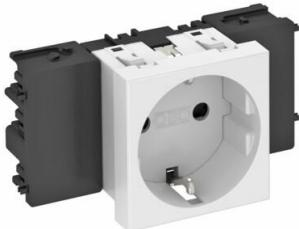
Prise de courant à contact de protection à raccordement latéral simple 0°, avec protection renforcée contre les contacts accidentels, avec bornes à fiche, 2 pôles, 16 A, 250 V~, avec bornes de raccordement selon CEI 60884-1, convient pour le montage dans les systèmes de canaux de montage d'appareillage Rapid 45.
