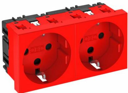
Prise de courant à contact de protection double 0°, version codée, avec protection renforcée contre les contacts accidentels, avec bornes à fiche, 2 pôles, 16 A, 250 V~, avec bornes de raccordement selon CEI 60884-1.
