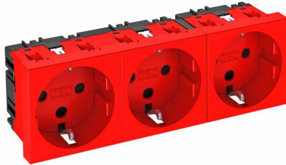
Prise de courant à contact de protection triple 0°, version codée, avec protection renforcée contre les contacts accidentels, avec bornes à fiche, 2 pôles, 16 A, 250 V~, avec bornes de raccordement selon CEI 60884-1.
