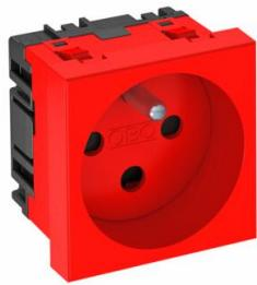
Prise de courant avec fiche de terre simple 0°, version détrompée, avec protection renforcée contre les contacts accidentels, avec bornes à fiche, 2 pôles, 16 A, 250 V~, avec bornes de raccordement selon CEI 60884-1.
