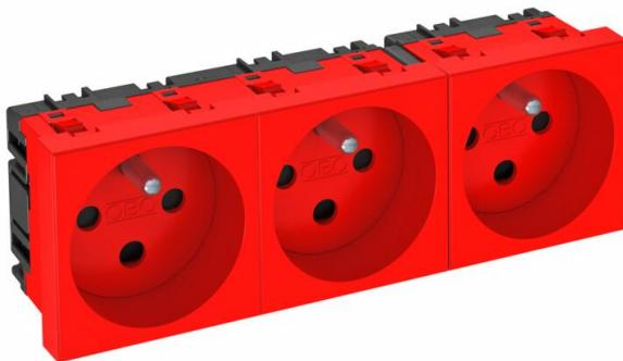
Prise de courant avec fiche de terre triple 0°, version détrompée, avec protection renforcée contre les contacts accidentels, avec bornes à fiche, 2 pôles, 16 A, 250 V~, avec bornes de raccordement selon CEI 60884-1.
