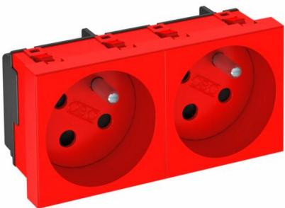
Prise de courant 2P+T double 33°, version détrompée, avec protection renforcée contre les contacts accidentels, avec bornes à fiche, 2 pôles, 16 A, 250 V~, avec bornes de raccordement selon CEI 60884-1.
