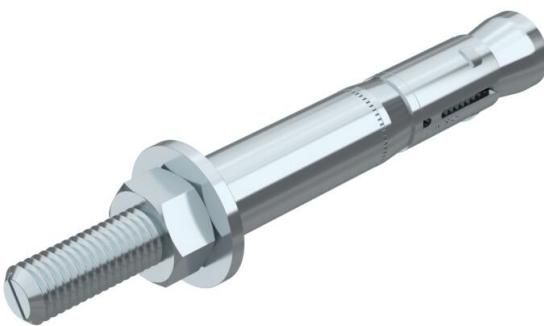
L'ancrage pour charges lourdes SZ est un système d'ancrage traversant hautement performant avec douille spéciale, à triple expansion, permettant des charges admissibles très élevées dans le cas d'entraxes et d'écartements entre les bords réduits.
