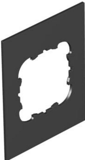
Plaque de support d'appareillages avec 1 perçage ( $\varnothing$  45 mm) pour un appareillage à griffe ou à vis, adaptée au côté longitudinal T12L (couvercle 1/4) ou au côté étroit T12L (couvercle 1/2).
