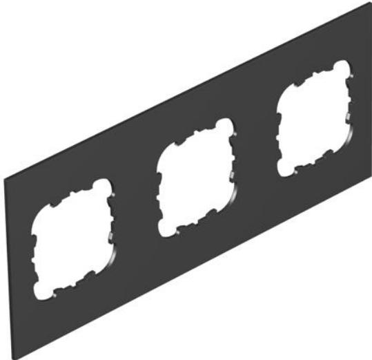
Plaque de support d'appareillages avec 3 perçages (Ø 45 mm) pour 3 appareillages à vis ou à griffe, adaptée au côté longitudinal T12L (couvercle 3/4)
