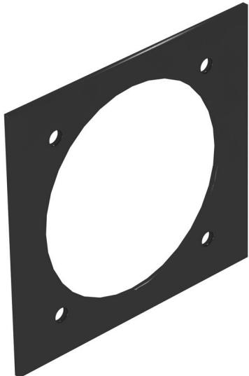
Plaque de support d'appareillages avec 1 perçage (Ø 70 mm) et fixation par vis 60 x 60 mm pour prises CEE, adaptée au côté longitudinal T12L (couvercle 1/3).
