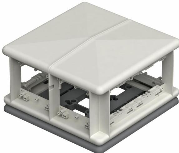
Unité d'appareillages saillante pour le montage de 8 appareillages simples à griffe ou à vis sur 4 côtés. La séparation des natures de courant (4 + 4) est assurée par une cloison de séparation. En cas d'utilisation d'appareillages multiples, la capacité de raccordement peut être augmentée. Mode de fixation par vis pour appareillages 60 mm à la verticale.
