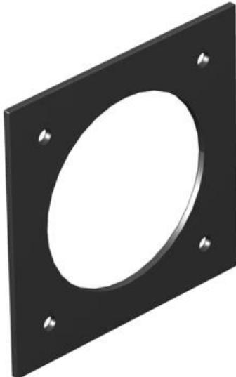
Plaque de support d'appareillages avec 1 perçage (Ø 70 mm) et fixation par vis 60 x 60 mm pour prises CEE, adaptée aux côtés étroits T4L et T8NL ou aux côtés longitudinaux T4L et T8NL (couvercle 1/2).
