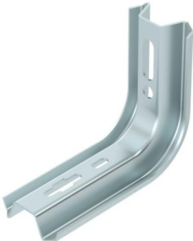
Montant/console TP à fixer sur les plafonds en béton horizontaux et aux murs. Si le profilé est fixé au plafond ou s'il est vissé contre la tête pour la renforcer, il convient pour des raisons de stabilité d'utiliser systématiquement l'entretoise de type DS 4.
