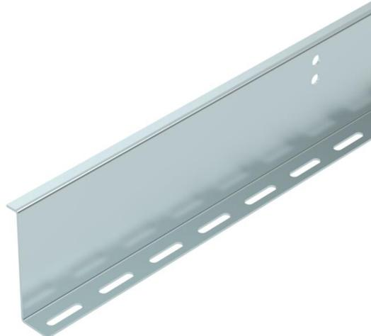
Séparateur pour système de chemins de câbles praticables BKRS. Fixation au moyen de boulons TRCC M 6 x 12 mm dans fond perforé.
