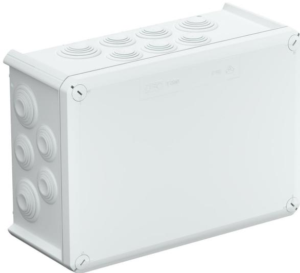
Boîte de dérivation pour le raccordement des câbles et conduits en intérieur et en extérieurs protégés. Forme rectangulaire avec des joints d'étanchéité sur les côtés et des entrées défonçables dans le fond. Convient pour le montage au mur / au plafond et sur des tôles de montage avec possibilité de fixation intérieure et de montage sur les dômes angulaires. Couvercle avec fermeture rapide, plombable. Fabriqué à partir de matériaux sans halogène. Version ignifuge en polypropylène spécial
