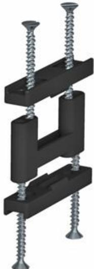
Pour câbles sous gaine jusqu'à Ø 16 mm, pour une fixation sur le séparateur. En cas d'utilisation dans T12L, 5 décharges de traction max. peuvent être utilisées ; dans T4B, 2 décharges peuvent être utilisées au max.
