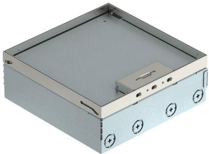
Boîte de sol carrée pour une utilisation dans des planchers creux et des chapes nettoyés à sec, utilisation à l'intérieur. Boîtier de montage avec ouvertures d'insertion défonçables pour tubes (M25). Couvercle réglable à l'aide de 4 supports de niveling sur le rebord supérieur du revêtement de sol. Évidement de 15 mm pour l'insertion du revêtement de sol dans le couvercle rabattable. La hauteur d'encastrement est de 95 mm au minimum, la plage de niveling 30 mm.
