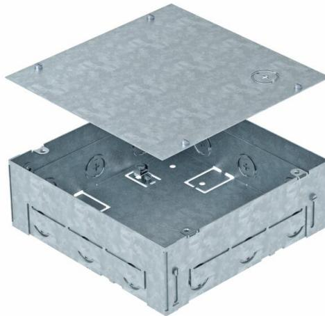
Boîtier de montage carré pour l'installation d'un boîtier de sol GES4-2 pour installation sous chape en intérieur. Avec ouvertures d'insertion défonçables pour tubes (M25), sur les quatre côtés.
