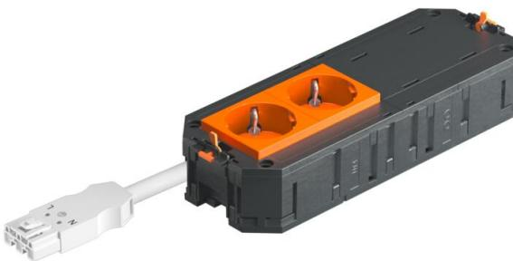
Le support universel prêt à raccorder UTC4 dispose de 2 prises de courant à contact de protection à 33° préinstallées, avec 16 A et 2 couvercles borgne pour le montage ultérieur de 2 appareillages de la série Modul 45. Convient pour les câbles de raccordement VL et les boîtiers de taille nominale R7, R9 et 9.
