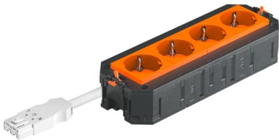
Le support universel prêt à raccorder UTC4 dispose de 4 prises à contact de protection à 33° préinstallées de couleur orange, 250 V~ 16 A. Convient pour les câbles de raccordement VL et les boîtiers de taille nominale R7, R9 et 9. Câble de raccordement avec fiche, 3 pôles, de type WINSTA® MIDI Le support universel prêt à monter UTC4 est équipé de 4 prises à contact de protection 33° orange pré-installés 250 V~16 A.
