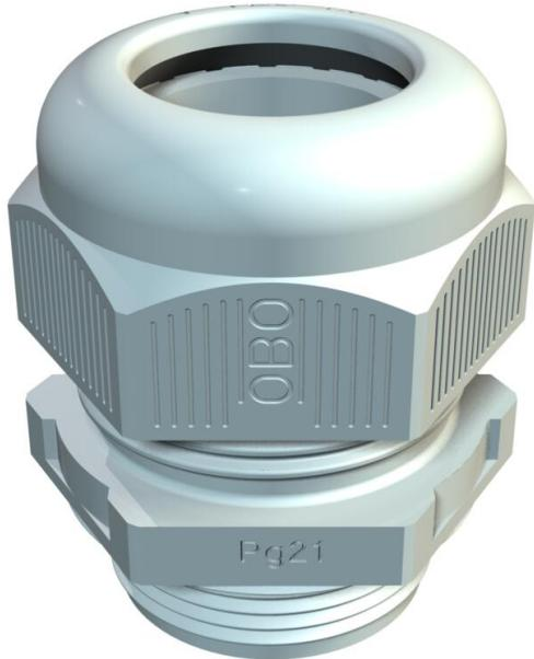
La façon la plus rapide et la plus simple pour garantir une décharge de traction et une étanchéité avec des presse-étoupes sur des boîtes de dérivation et des boîtiers est l'utilisation des presse-étoupes V-TEC VM OBO éprouvés. Grâce à la lèvre d'étanchéité intégrée et à la technique de lamelles OBO spéciale, l'indice de protection IP68 est atteint. La décharge de traction et l'étanchéité sont contrôlées selon la norme DIN EN 62444
