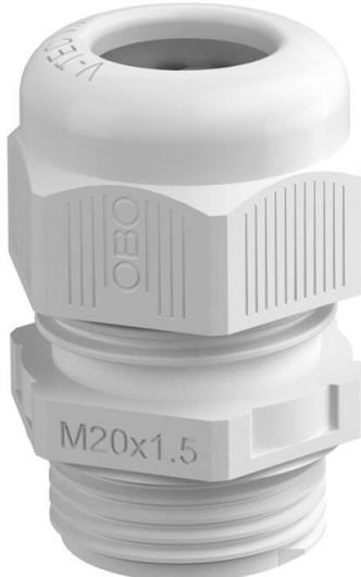
La façon la plus rapide et la plus simple pour garantir une décharge de traction et une étanchéité avec des presse-étoupes sur des boîtes de dérivation et des boîtiers est l'utilisation des presse-étoupes V-TEC VM OBO éprouvés. Grâce à la lèvre d'étanchéité intégrée et à la technique de lamelles OBO spéciale, l'indice de protection IP68 est atteint. La décharge de traction et l'étanchéité sont contrôlées selon la norme DIN EN 62444
