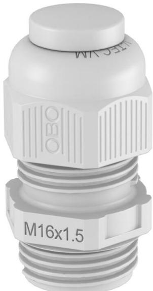
Presse-étoupe avec raccord fileté métrique de type écrou borgne, pour boîtes de dérivation, boîte, coffrets de distribution dans le domaine privé et industriel. Avec décharge de traction et lèvre d'étanchéité intégrée, testé selon la norme DIN EN 62444. Indice de protection IP68. Utilisation possible de -20 °C à +65 °C. Cela permet de fermer sans difficulté des ouvertures non utilisées. La poussière ou l'eau ne pouvant pénétrer, l'indice de protection est maintenu.
