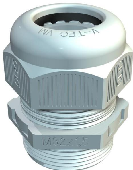
La façon la plus rapide et la plus simple pour garantir une décharge de traction et une étanchéité avec des presse-étoupes sur des boîtes de dérivation et des boîtiers est l'utilisation des presse-étoupes V-TEC VM OBO éprouvés. Grâce à la lèvre d'étanchéité intégrée et à la technique de lamelles OBO spéciale, l'indice de protection IP68 est atteint. La décharge de traction et l'étanchéité sont contrôlées selon la norme DIN EN 62444
