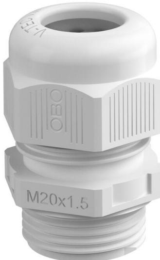
La façon la plus rapide et la plus simple pour garantir une décharge de traction et une étanchéité avec des presse-étoupes sur des boîtes de dérivation et des boîtiers est l'utilisation des presse-étoupes V-TEC VM OBO éprouvés. Grâce à la lèvre d'étanchéité intégrée et à la technique de lamelles OBO spéciale, l'indice de protection IP68 est atteint. La décharge de traction et l'étanchéité sont contrôlées selon la norme DIN EN 62444
