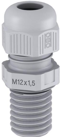
La façon la plus rapide et la plus simple pour garantir une décharge de traction et une étanchéité avec des presse-étoupes sur des boîtes de dérivation et des boîtiers est l'utilisation des presse-étoupes V-TEC VM OBO éprouvés. Grâce à la lèvre d'étanchéité intégrée et à la technique de lamelles OBO spéciale, l'indice de protection IP68 est atteint. La décharge de traction et l'étanchéité sont contrôlées selon la norme DIN EN 62444
