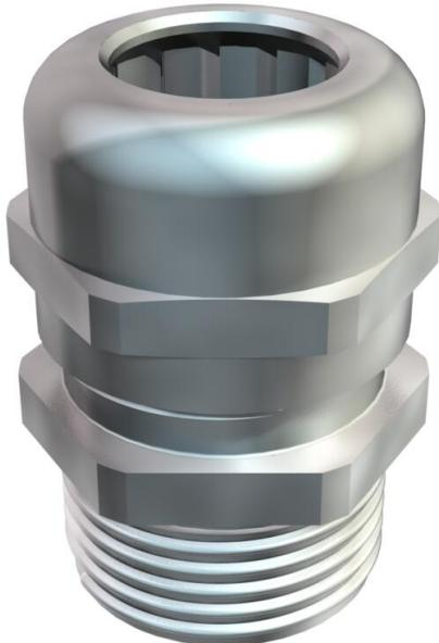
Presse-étoupe robuste de type écrou borgne avec filetage métrique selon la norme CEI 423, pour des exigences d'étanchéité élevées. Décharge de traction, protection anti-torsion sur toute la plage de serrage. Pour parois de boîtiers épais en association avec des contre-écrous. Bague d'étanchéité en néoprène. Garniture de serrage en polyamide. Avec bague d'étanchéité prémontée sur le raccord fileté, testé VDE selon la norme DIN EN 50262, indice de protection IP 68 à 5 bars/1 h.
