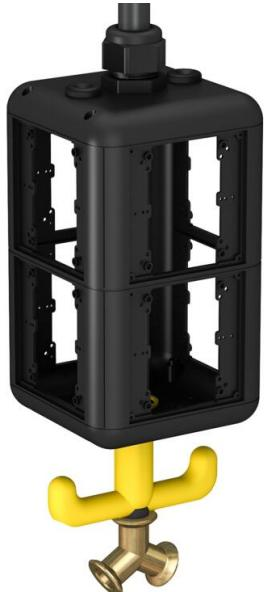
Boîtier vide avec 1 m de tuyau 1/2" et raccordement pour flexible d'air comprimé 13 x 3,5 mm et distributeur 2 voies 1/2". Avec oeillets de suspension et poignée crochet, pour montage de 4 instruments électriques, avec cloison de séparation jointe. Sans plaque de recouvrement.
