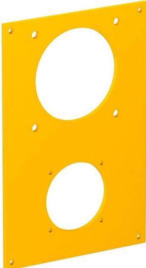
Plaque de recouvrement avec une ouverture de Ø45 mm pour le montage d'une prise de courant encastrée (type ASD-...) avec bande de fixation de 38 mm et une ouverture de Ø60 mm pour le montage d'une prise de courant CEE 16/32 A avec bande de fixation de 60 mm, incluant 8 vis pour la fixation de l'appareillage.
