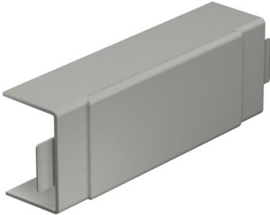
Pièces en Té et en croix pour changer la direction des goulottes WDK. La pièce de forme est pré-perforée sur le côté pour relier différentes sections de goulotte. Les pièces de forme se positionnent par recouvrement.
