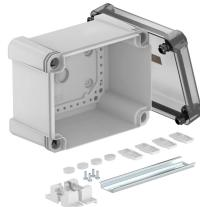
Boîte de dérivation avec rail DIN profilé pour connecter des câbles et des conduites en intérieur et en extérieur.. Forme rectangulaire sans ouvertures. Convient pour le montage au mur / au plafond avec possibilité de fixation extérieure, de fixation intérieure ou de montage sur les dômes d'angle. Particulièrement résistant aux chocs avec IK09 Couvercle transparent avec fermeture rapide, plombable. Fabriqué à partir de matériaux sans halogène et résistant aux UV.
