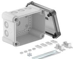
Boîte de dérivation avec rail DIN profilé pour connecter des câbles et des conduites en intérieur et en extérieur.. Forme rectangulaire avec entrées défonçables. Convient pour le montage au mur / au plafond avec possibilité de fixation extérieure, de fixation intérieure ou de montage sur les dômes d'angle. Particulièrement résistant aux chocs avec IK09 Couvercle transparent avec fermeture rapide, plombable. Fabriqué à partir de matériaux sans halogène et résistant aux UV.
