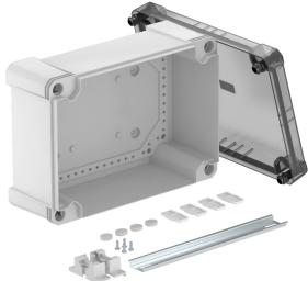
Boîte de dérivation avec rail DIN profilé pour connecter des câbles et des conduites en intérieur et en extérieur.. Forme rectangulaire sans ouvertures. Convient pour le montage au mur / au plafond avec possibilité de fixation extérieure, de fixation intérieure ou de montage sur les dômes d'angle. Particulièrement résistant aux chocs avec IK08. Couvercle transparent avec fermeture rapide, plombable. Fabriqué à partir de matériaux sans halogène et résistant aux UV.
