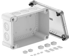
Boîtier de dérivation pour le raccordement de câbles et conduits en intérieur et en extérieurs protégés. Forme rectangulaire avec entrées défonçables. Convient pour le montage au mur / au plafond avec possibilité de fixation extérieure, de fixation intérieure ou de montage sur les dômes d'angle. Particulièrement résistant aux chocs avec IK08. Couvercle transparent avec fermeture rapide, plombable. Fabriqué à partir de matériaux sans halogène et résistant aux UV.
