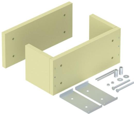
Décharge de traction comme mesure efficace pour pose verticale de câbles selon DIN 4102 partie 12. Homologation pour tout type de câbles et tous les systèmes de pose verticaux Classes de maintien en fonction E30 à E90. Boîtier vide pour un remplissage individuel avec de la mousse coupe-feu PYROSIT® NG et/ou des blocs de mousse PYROPLUG®, avec Kit de montage et étiquette.
