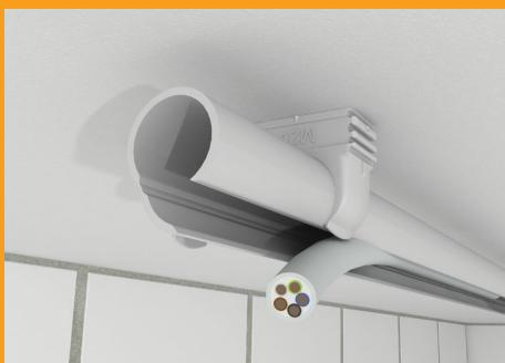
**1** Insérer le câble dans le tube Quick Pipe.
