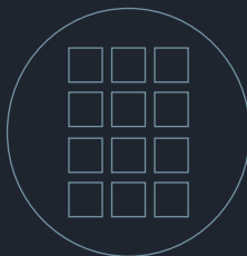
12 x Modul 45 Dimensions extérieures Ø 324 mm
