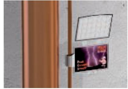
mations sur les dommages potentiels causés à l'installation électrique. La carte PCS s'installe dans un support de carte clipsé sur du conducteur rond à une distance donnée. La plage de détection de la carte va de 3 à 120 kA. Le lecteur de carte magnétique permet de lire les valeurs stockées sur les cartes. La valeur crête d'intensité est affichée sur l'écran.
