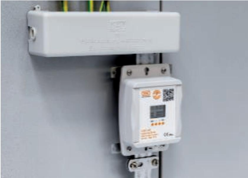
Le compteur d'impacts de foudre et de surtensions LSC I+II détecte les courants de choc de décharge (onde 10/350) et courants de décharge (onde 8/20) et enregistre chaque événement avec horodatage.
